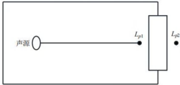
图 4-1 室内声源等效为室外声源图例
