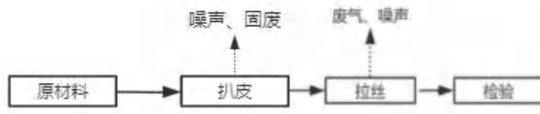
图 2-2 本项目冷拉生产工艺流程图
