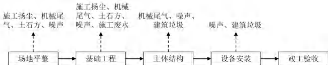
图 2-2 施工期主要工艺流程及产排污环节示意图
