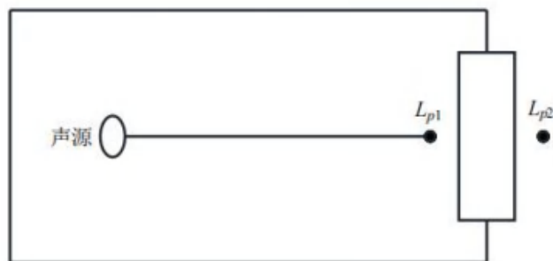
图 4-1 室内声源等效为室外声源图例
