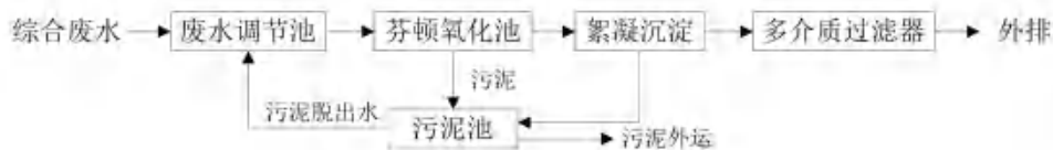
图4-4综合废水处理工艺流程图
