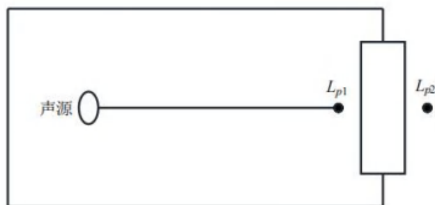
图 4-1 室内声源等效为室外声源图例
