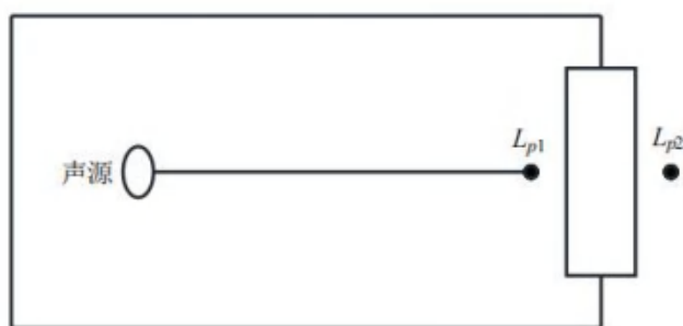
图 4-1 室内声源等效为室外声源图例
