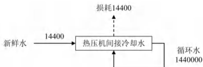
图 2-1 经改造后的冷却水系统水平衡图 单位：m 3 /a
