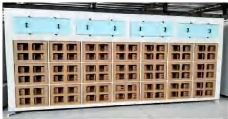
图 4-1 干式漆雾过滤器装置示意图
