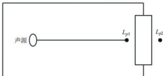
图 4-1 室内声源等效为室外声源图例
