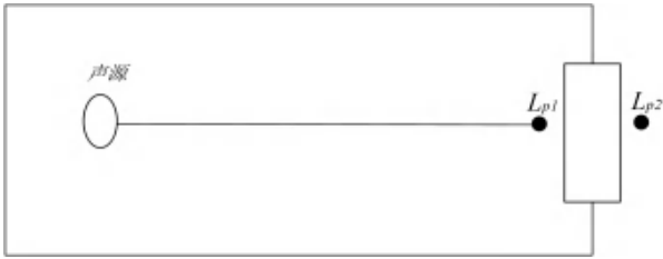
图 4-1 室内声源等效为室外声源图例
