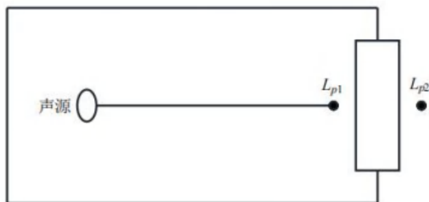
图 4-1 室内声源等效为室外声源图例
