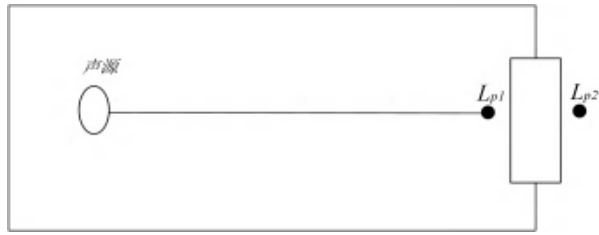
图 4-1 室内声源等效为室外声源图例
