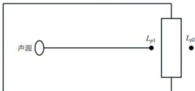
图 4-1 室内声源等效为室外声源图例
