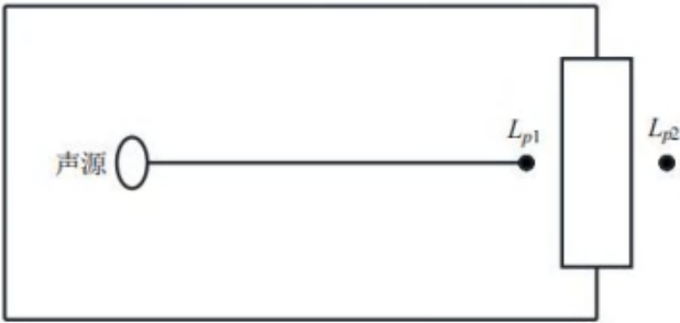
图 4-1 室内声源等效为室外声源图例
