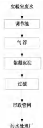
图 4-1 实验废水预处理工艺流程图
