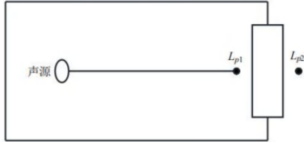
图 4-2 室内声源等效为室外声源图例
