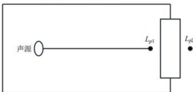
图 4-1 室内声源等效为室外声源图例
