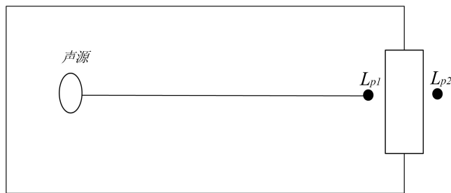
图 4-1 室内声源等效为室外声源图例
