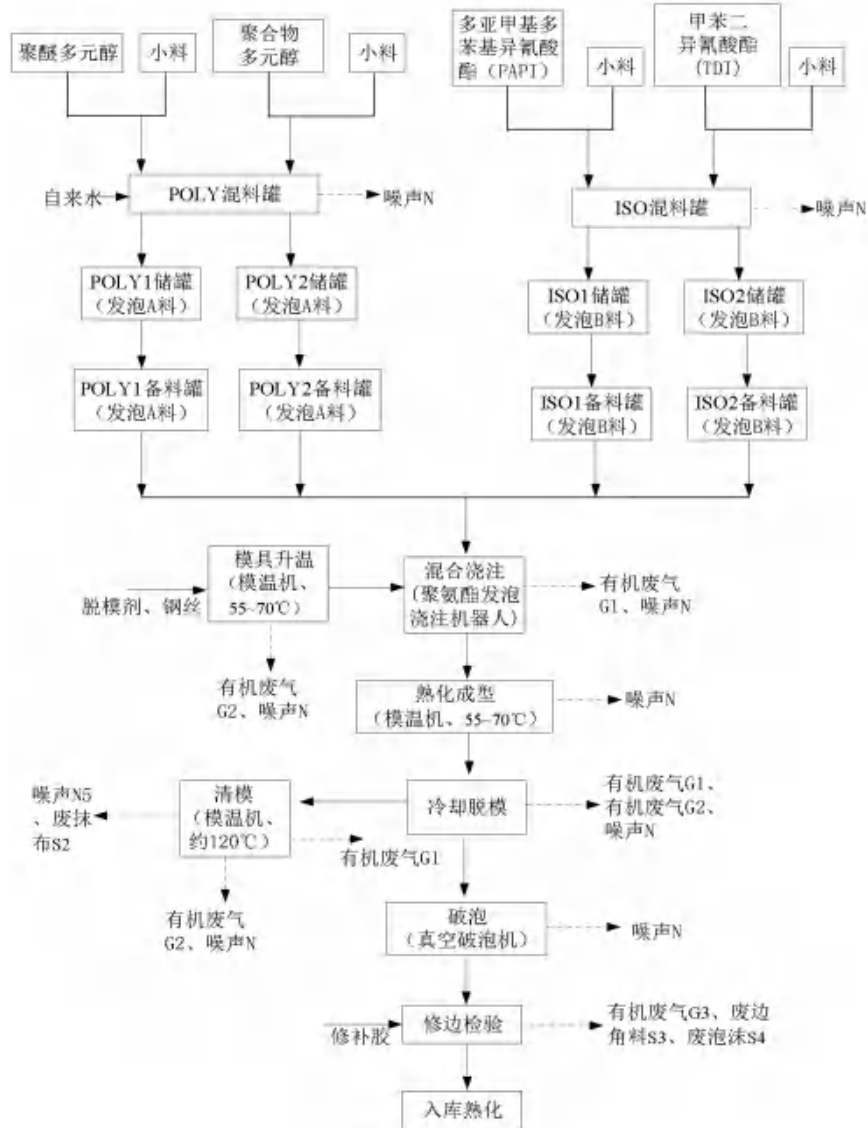
图 2-3 座椅泡沫生产工艺流程及产污位置
