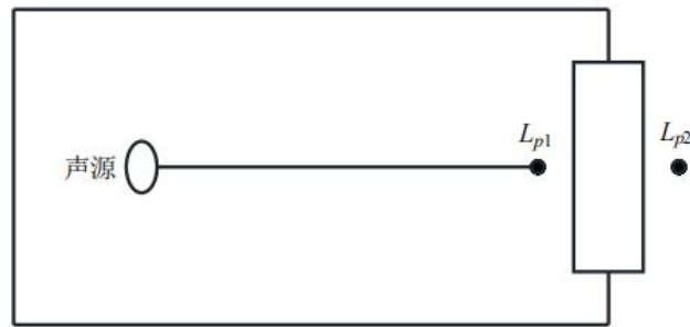
图 4-1 室内声源等效为室外声源图例
