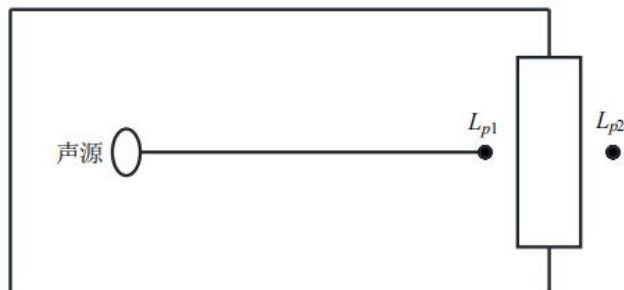
图 4-1 室内声源等效为室外声源图例
