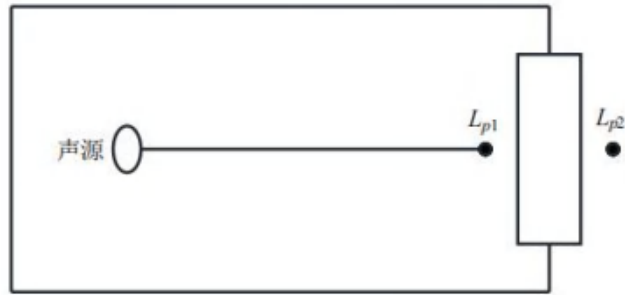
图 4-1 室内声源等效为室外声源图例
