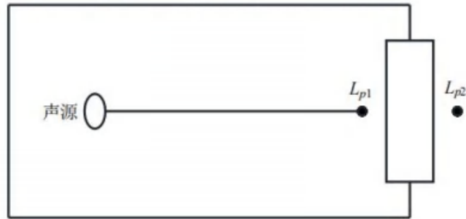
图 4-1 室内声源等效为室外声源图例
